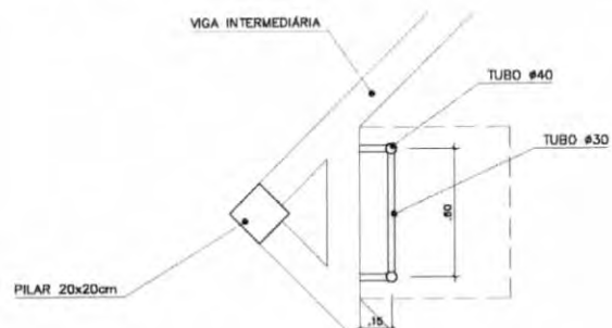
PLANTA INFERIOR ESCADA MARINHEIRO ESC.: 1 / 20
